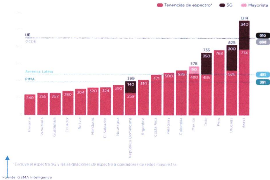
Figura 2. Tendencias de espectro en América Latina a cierre de 2022 (en MHz, excluye bandas milimétricas)
