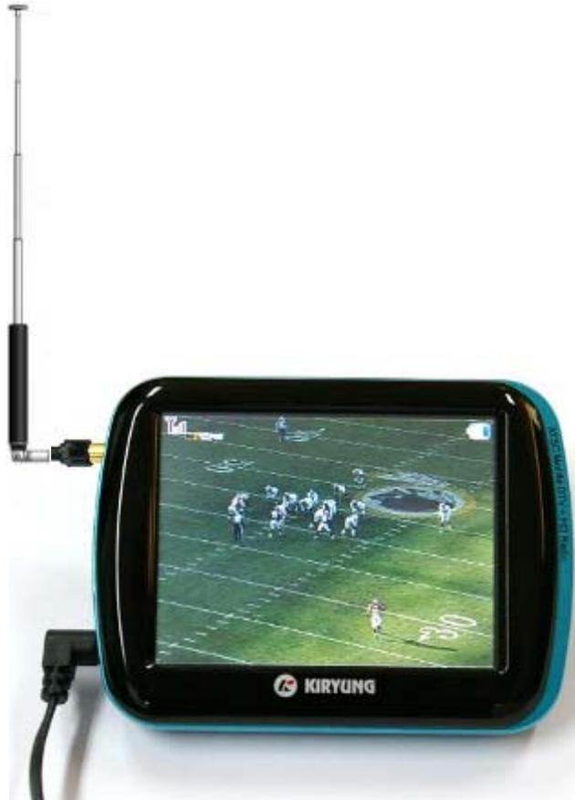
Receptor portátil de HDTV y HD Radio de KRI (ATSC M/H)
