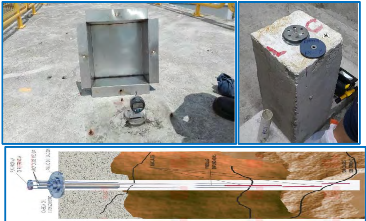
Figura N° 10: Extensómetros de varilla. Fuente: Alternegy, S.A.
