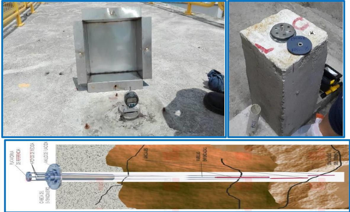
Figura N° 10: Extensómetros de varilla. Fuente: Alternegy, S.A.
