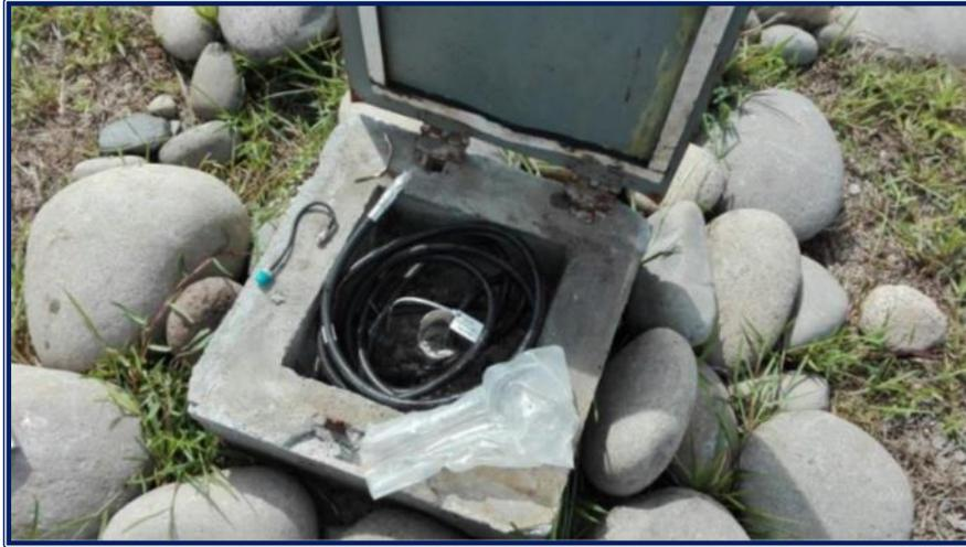
Figura N°13: Inclinómetro instalado en el canal de Aducción de Prudencia.
