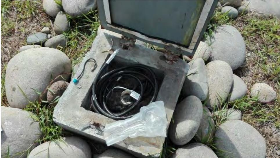
Figura N° 4 – Uno de los inclinómetros del canal de aducción. Fuente: Alternegy, S.A.
