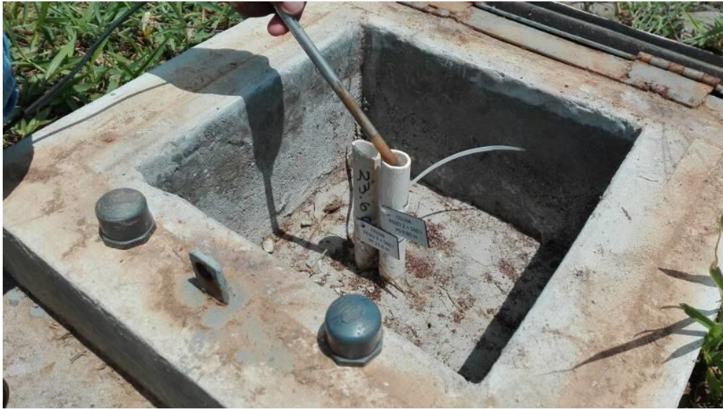
Figura N° 3: –Piezómetro Abierto en los Canales de Aducción de la CH Lorena. Fuente: Alternegy, S.A.
