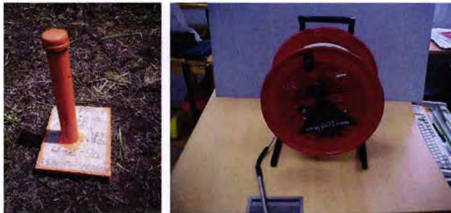
Figura No 8. Piezómetro y galvanómetro para medir el nivel freático. Fuente: Consultor, mayo de 2013.
