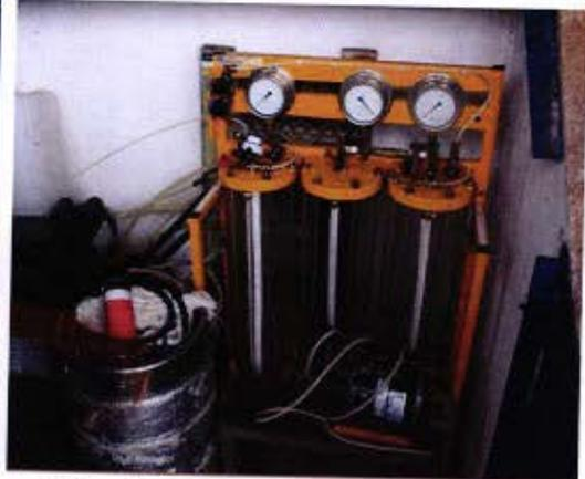
Figura No 9. Celda hidráulica de carga y ubicación en la Presa. Fuente: Consultor, mayo 2013.
