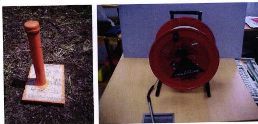
Figura No 8. Piezómetro y galvanómetro para medir el nivel freático.
