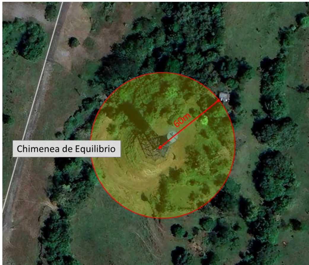
Figura N° 8 – Ubicación de la chimenea de equilibrio
