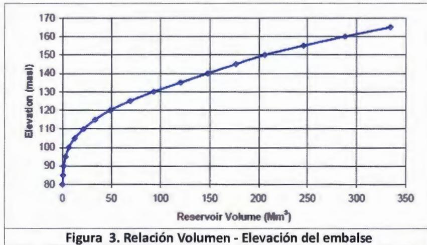
**Figura 3. Relación Volumen - Elevación del embalse**
