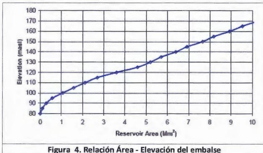
**Figura 4. Relación Área - Elevación del embalse**
