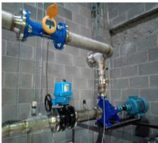
Figura 5: Vista de la turbina ensamblada, medidor de torque en línea y generador de inducción
