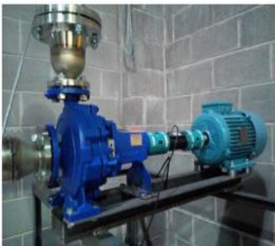
Figura 5: Vista de la turbina ensamblada, medidor de torque en línea y generador de inducción
