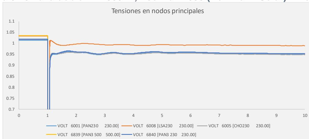
**Figura 9.24 Falla doble 4LT 500kV, Esc. Iluv 2035 (DemMax - Solar) – STATCOMs**
