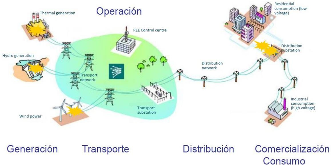
Figura 3. 1: Generación, Transmisión y Distribución de energía eléctrica <sup>13</sup>.
