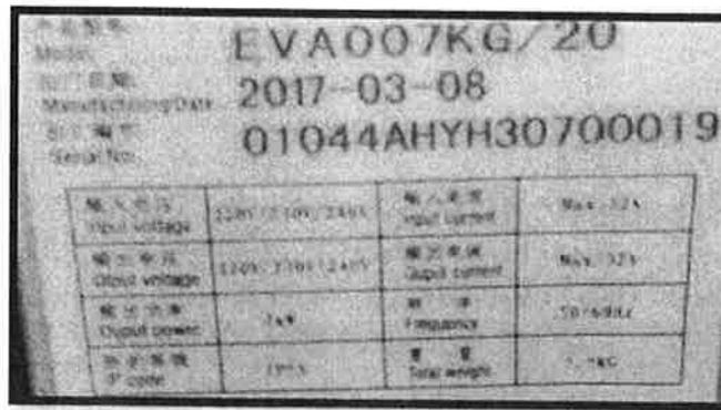
Figura No.2 Especificaciones del cargador.
