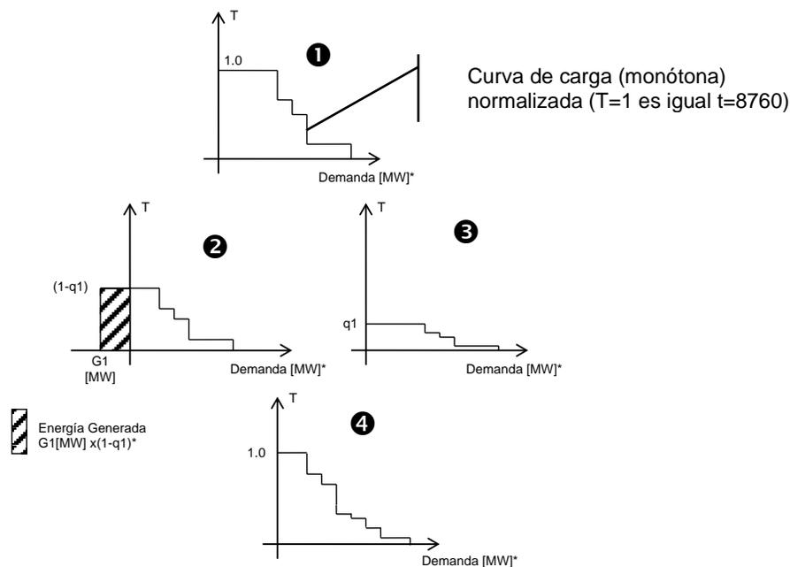
**PASO II:** Determinar la energía que no es abastecida por G1. Esta consta de dos componentes.
