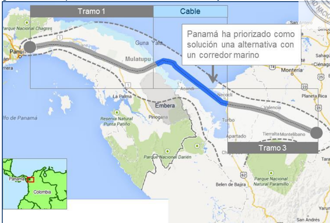
Figura 9. 1: Trazado previsto de la interconexión entre Panamá II y Cerromatoso
