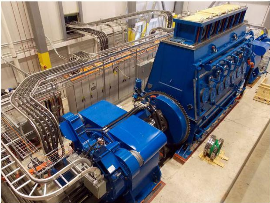
Figura 2. 36: Almacenamiento de Aire comprimido Isotérmico de la Compañía SustainX.
