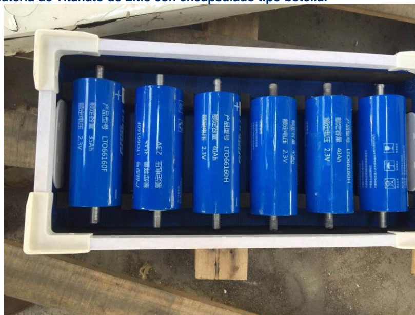
Figura 2. 48: Batería de Titanato de Litio con encapsulado tipo botella.
