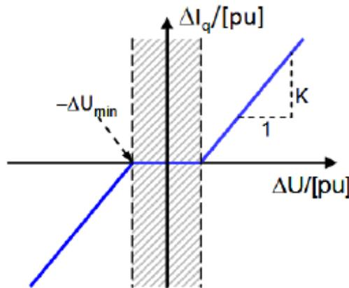
*Figura 5.2: Cálculo de la Corriente reactiva de Falla.*
